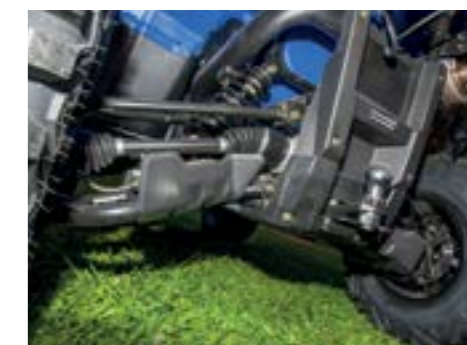
Hinterachse: Sperrbares Diff & kurzer Hängerhaken
