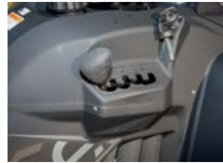
Schaltkulisse: beim Testfahrzeug sehr hakelig
