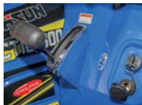
Schaltkulisse: funktioniert auch am Hang butterweich
