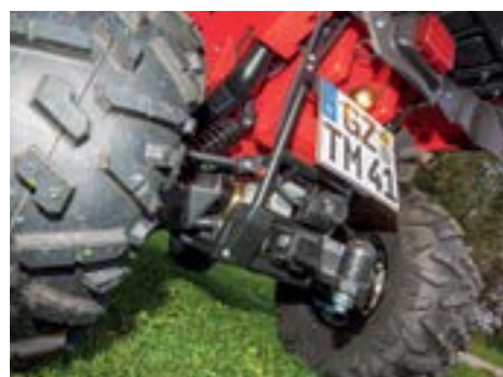
Hinterachse: ohne sperrbares Differenzial
