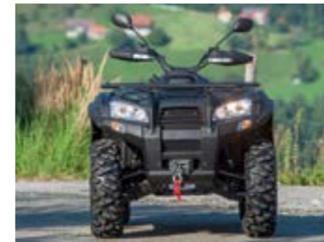
14-Zoll-Räder, Seilwinde und 123 cm breit
