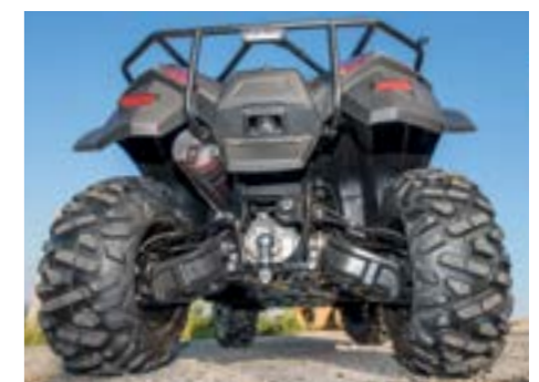
Hinterachse: mit sperrbarem Differenzial
