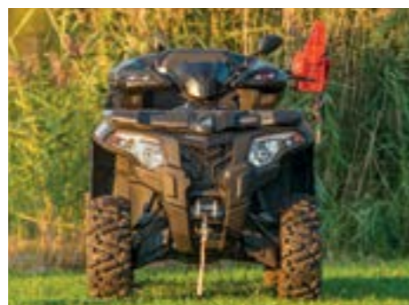
12-Zoll-Räder, Seilwinde und knapp 1,2 m Breite
