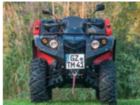
12-Zoll-Räder, Seilwinde und 119,4 cm breit
