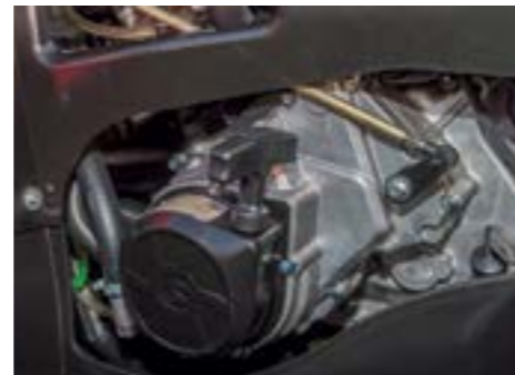
Gut: zusätzlicher Seilzug-Starter bei Stels und Hisun
