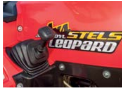
Schaltkulisse: etwas haklig, Parkstellung fehlt
