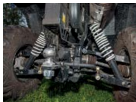
Hinterachse: Einzelrad-Aufhängung aber kein Diff
